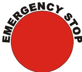
**Emergency stop:** Кнопка для аварийной остановки движения по осям и шпинделя. Кнопка остается в нажатом положении. Для освобождения поверните головку против часовой стрелки.
